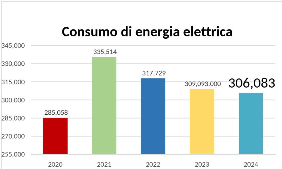
Il consumo di energia elettrica è diminuito grazie ad una ottimizzazione del processo produttivo e ad alcuni interventi effettuati per ridurre i consumi. Nell'Anno 2023 sono stati installati i Nuovi Reattori Rotanti per l'impianto di Affinazione Oro. Questo ha permesso un maggior efficientamento sull'utilizzo degli Acidi di lavorazione e sul consumo di Energia elettrica sia in fase attiva di funzionamento
